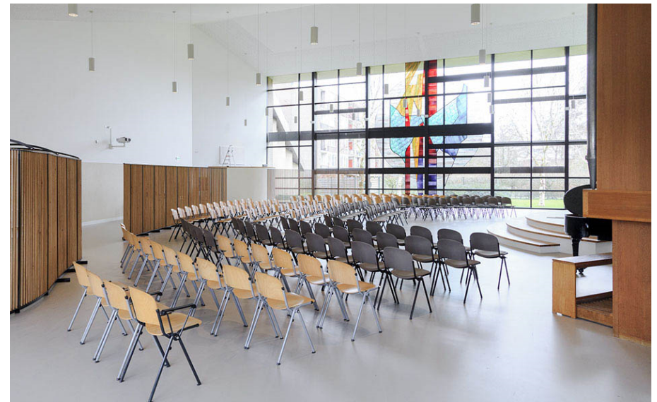
voorbeeld van demontabele en verplaatsbare schermen (Taborkerk Purmerend)
